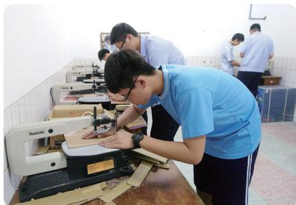
線鋸機製作液壓手臂
